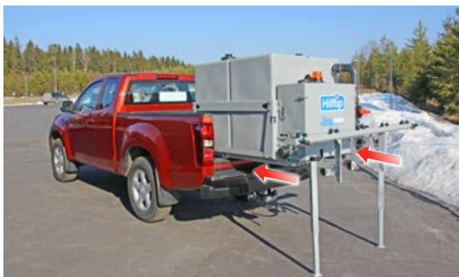
Stativ (tillval) med rullskenor för att enkelt föra över och avlägsna vätskespridaren från fordonet.
