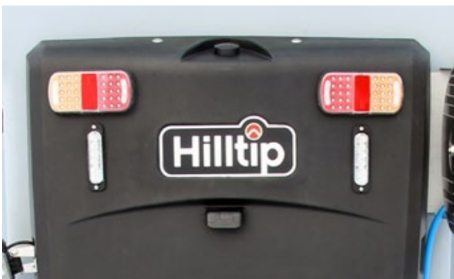
LED bakljus och varningsljus
